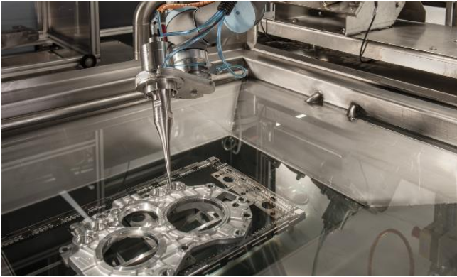
Eine Stabsonotrode ermöglicht die gezielte und selektive Entgratung von einzelnen Bereichen oder Bohrungen und komplexen Geometrien.
