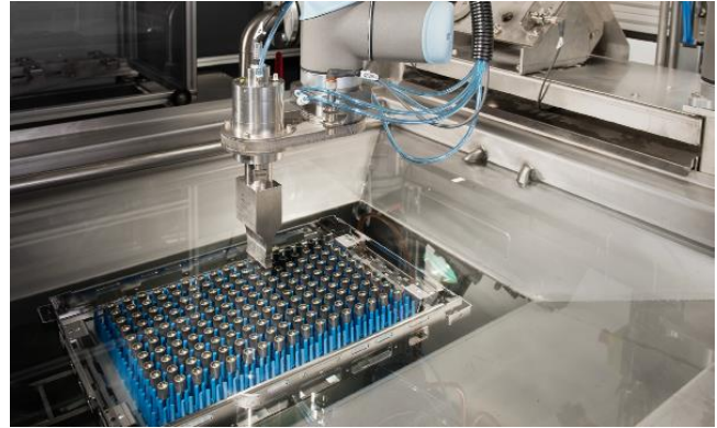
Mittels Messersonotrode ist die flächige Entgratung von gefrästen Flächen oder auch von Setzware effizient möglich.
