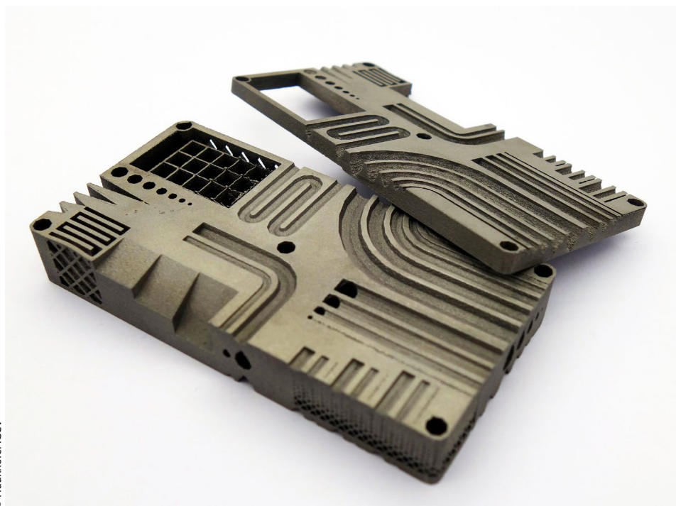
Komplexe Strukturen sind – wie bei diesem Testkörper – ein Merkmal additiv gefertigter Bauteile.
