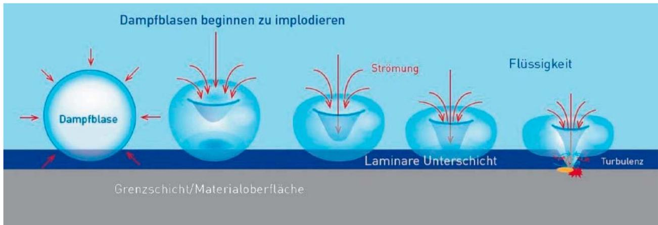
Im Cyclic Nucleation Process entstehen Dampfblasen und implodieren. Das erzeugt Strömungen an der Grenzschicht zwischen Flüssigkeit und Material sowie Turbulenzen und mechanische Kräfte, die insgesamt den Reinigungseffekt ergeben
