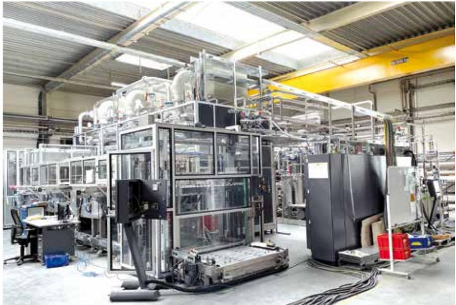
Eine Ultra-Feinstreinigungsanlage für die Hochvakuumtechnik kurz vor der Fertigstellung: Gerade in der Endmontage ist besonderes Augenmerk auf die technische Umsetzung der Anforderungen gefragt.
