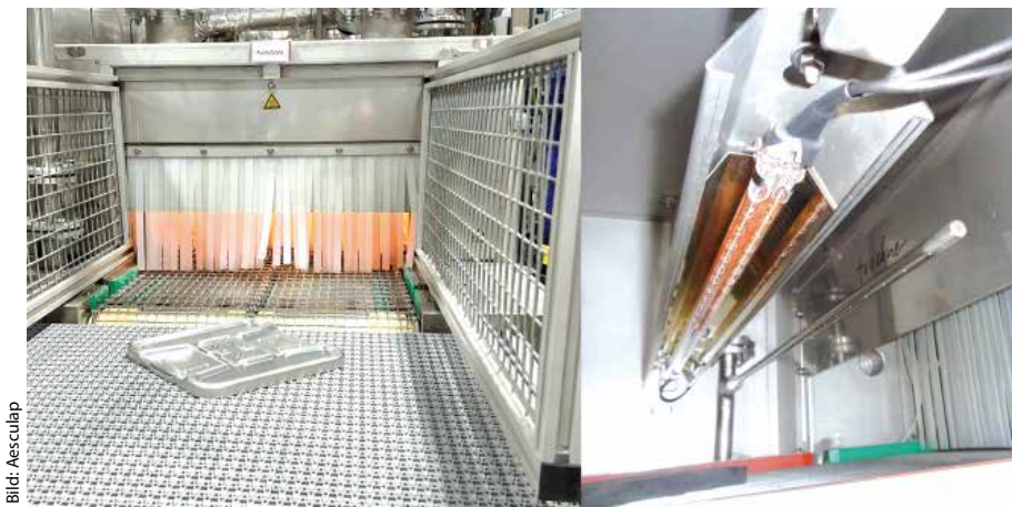
Die Containerdeckel von Aesculap werden nach den Reinigungs- und Spülprozessen in einer Kombination aus Heißluft und Infrarot-Strahlungswärme final getrocknet.
