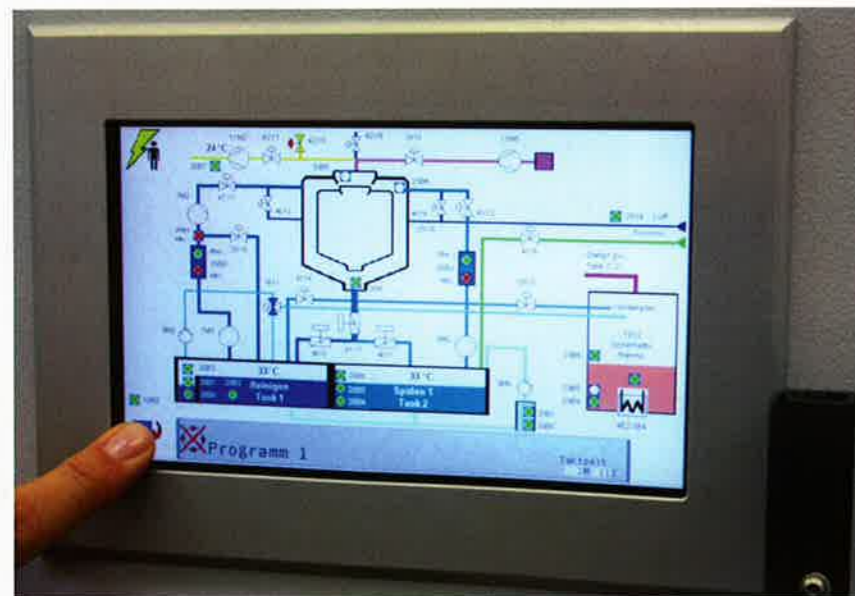
Bild 2: Einfach zu bedienen: Das praktische Touch-Screen-Display gehört zur Standard-Ausstattung der Reinigungsanlage (Werkbilder: LPW Reinigungssysteme GmbH, Riederich)
