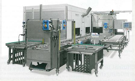
Betriebskosten gegenüber den klassischen offenen Varianten um bis zu 40 Prozent gesenkt. Die Anlagen sind so konzipiert, dass sie sich auch ohne besondere Vorkenntnisse schon nach kurzer Einweisung bedienen, warten und instand halten lassen. Dank des Touch-Screen-Displays können die Anlagen leicht an verfahrenstechnische Aufgaben angepasst werden. Je nach Anforderung lässt sich das System in den drei Basisvarianten (compact, inline und topload) mit bis zu fünf Bädern, ein bis drei
