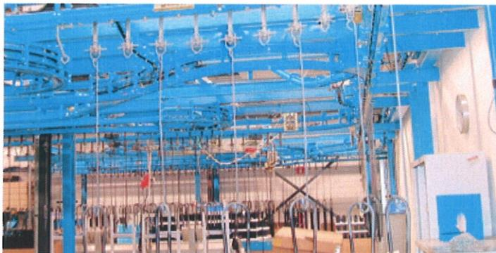
Optimal ausgelegte Fördereinrichtungen sorgen dafür, dass die zu beschichtenden Werkstücke wirtschaftlich und sicher zu den einzelnen Stationen der Oberflächenbehandlung gelangen. *Quelle: Kewesta*
