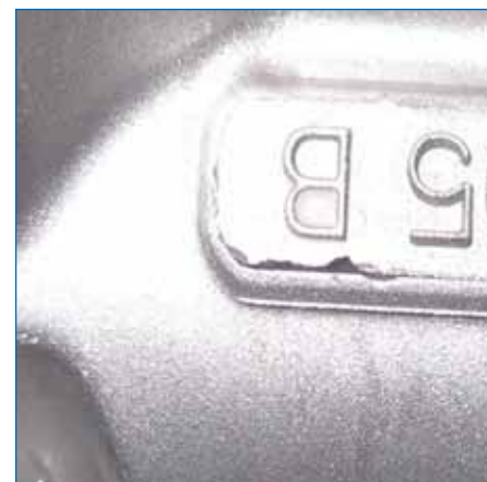
Bild 1: Schon bei der Konstruktion der Druckgussformen – also noch weit vor dem eigentlichen Produktionsprozess – lassen sich die Weichen für eine erfolgreiche Endreinigung stellen. Hier könnten Flittergradrückstände das Reinigungsergebnis beeinträchtigen.
