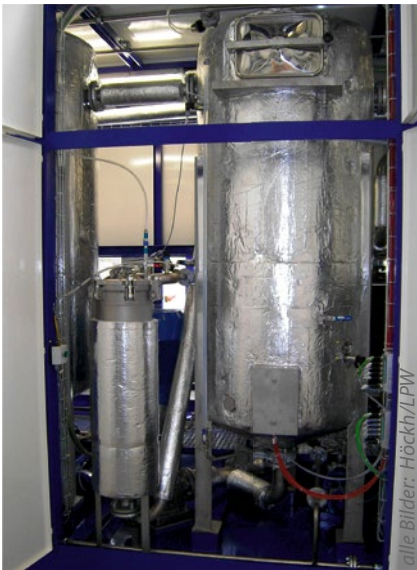
Stehende Tanks ermöglichen eine platzsparende Anordnung sowie gute Zugänglichkeit zu Tank, Filter und Pumpe. Bei diesem Beispiel erfolgt eine Vierfach-Filtration im Vor-/Rücklauf sowie eine Umwälzung von Arbeitskammer und Tank.
