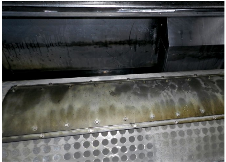
Beispiel unten liegende Tanks: rotierende Siebtrommeln scheiden unmittelbar nach der Behandlungskammer Grobverschmutzungen im Vollstrom ab und führen diese mittels Kratzförderern der Entsorgung zu.
