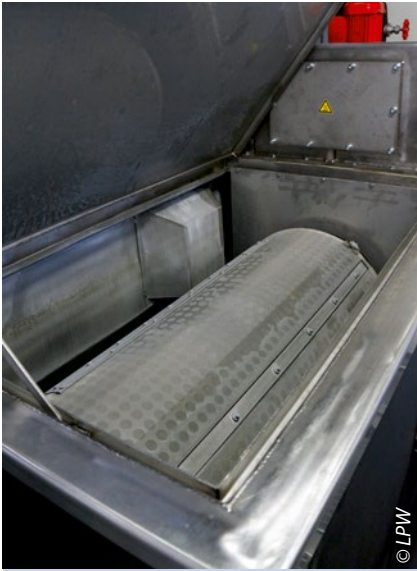
Direkter Späne- und Grobschmutzaustrag durch automatische Siebtrommel mit integriertem Späneförderer im Vollstrom
