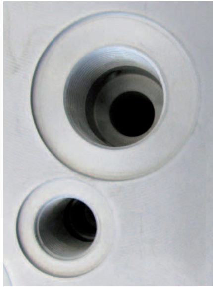
Die Abbildungen zeigen ein Werkstück, das nach dem thermischen Entgraten gereinigt werden musste, um die dabei entstandene Oxidschicht zu entfernen.
