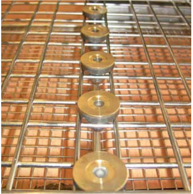
Nach der Reinigung dürfen die Bauteile keine metallischen Partikel größer 400 µm aufweisen. Als Reinigungszeit pro Bauteil wurden neun Sekunden kalkuliert.
