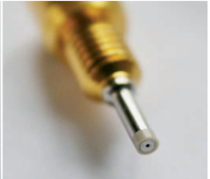
Durch diese kleinen Öffnungen ist in Bezug auf partikuläre und filmische Kontaminationen eine ausreichende Reinigung zu gewährleisten.
