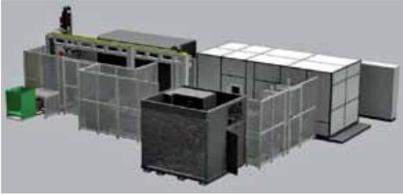
Zwei Unternehmen der Allianz realisierten dieses vollautomatisierte Gesamtsystem für die Automobilindustrie. Integriert wurde eine Anlage zur thermischen Entgratung, eine Doppelkammer-Reinigungsanlage und eine Lösemittelkonservierung.
