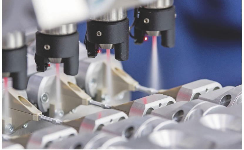
CO 2 -Schneestrahln reinigen ermöglicht effizientes, partielles Inline-Reinigen von Funktionsflächen, etwa vor dem Laserschweißen. Mit minimalem Digitalisierungsaufwand lassen sich die Reinigungsqualität direkt am Werkstück überwachen und die Werte an übergeordnete Systeme übermitteln.
