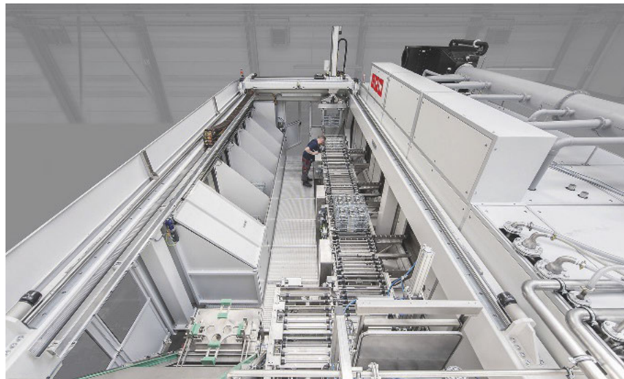
Hocheffiziente und intelligente Getriebe stellen hohe Anforderungen an die Bauteilsauberkeit. Diese Anlage fürs Reinigen von Getriebebauteilen ist mit drei Arbeitskammern und einem vorgeschalteten Flächenportal für Wellen und Räder ausgestattet. Bild: LPW Reinigungssysteme
