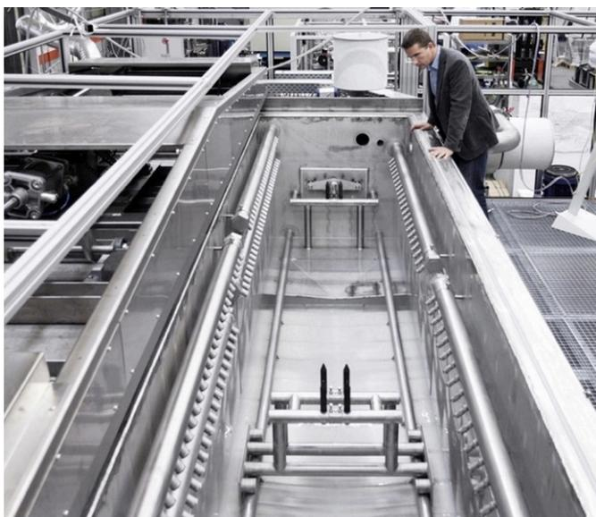
2. Die Kammertechnologie eignet sich auch für die Feinreinigung von Großbauteilen (hier: ca. 4.000 x 700 x 700 mm Aluminium). (Fotos/Schaubilder: LPW Reinigungssysteme GmbH)
