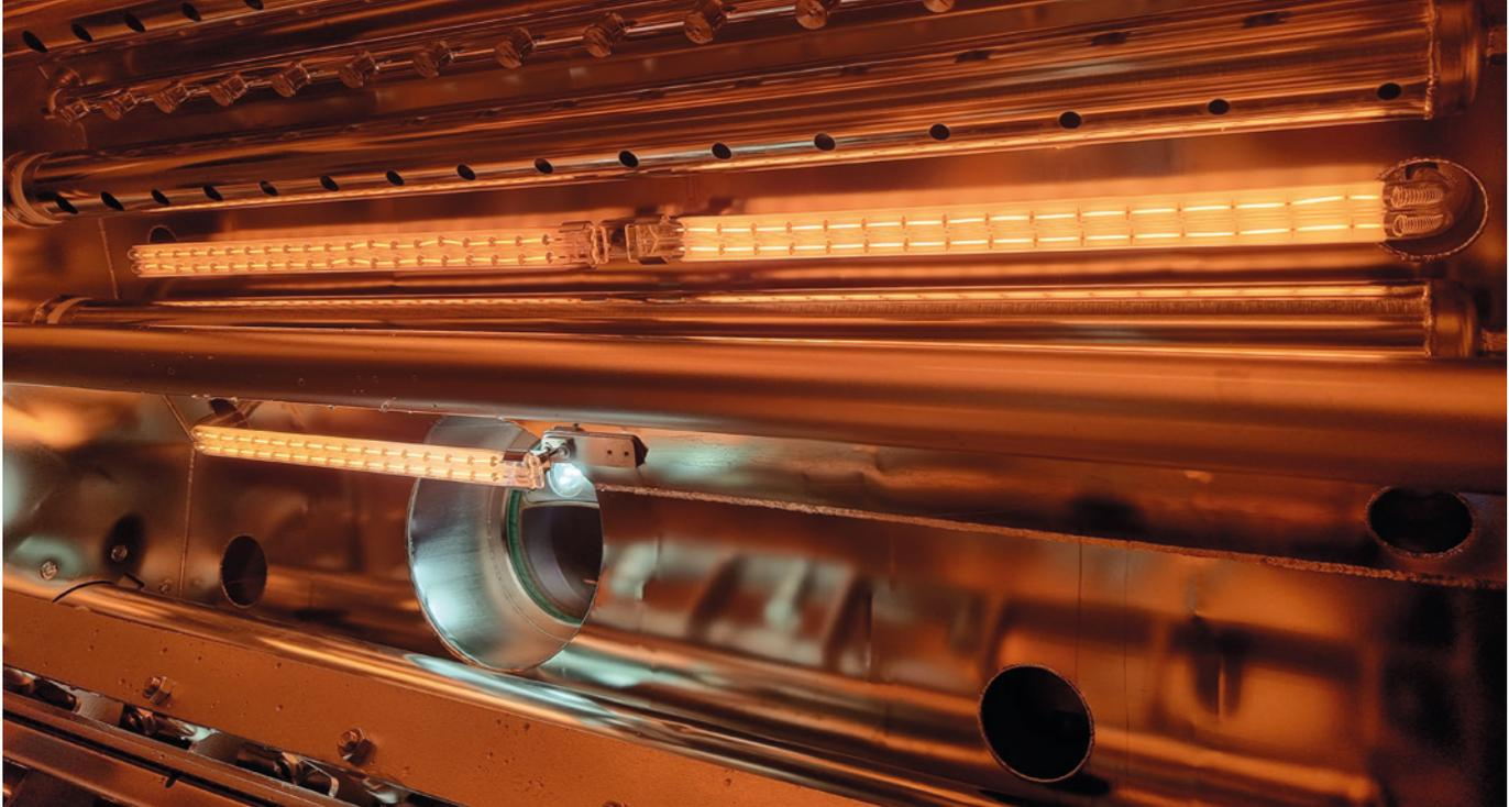
*Die Einflüsse der Trocknung auf den Grad der Technischen Sauberkeit werden häufig unterschätzt. So neigt die energieeffiziente Umlufttrocknung zur Aufkonzentration feinsten organischer und anorganischer Verunreinigungen, was die Re-Kontamination der Bauteile zur Folge hat. Daher setzt LPW umgebungsentkoppelte Infrarotsysteme ein. (Foto: LPW)*
