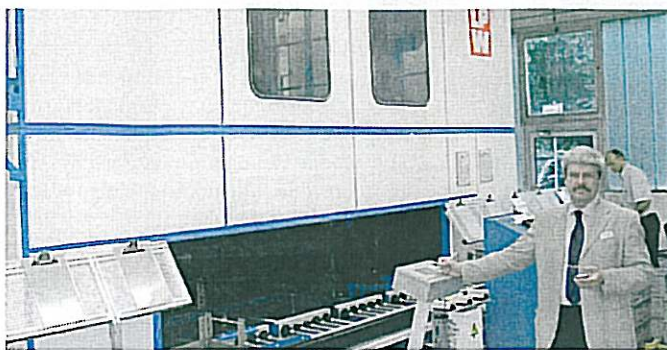
LPW-Verkaufsleiter Thomas Daiber ist vom Konzept der Anlage, bei der ein Toplader kombiniert wurde mit einer Einkammermaschine mit Vollstromfiltration, überzeugt.
