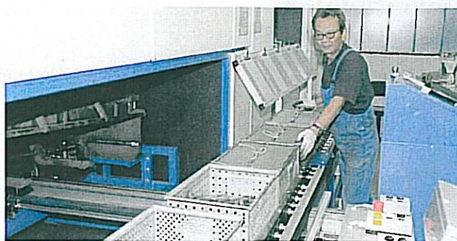
Die Beladung der Anlage erfolgt von einer Seite, das Ausschleusen der gereinigten Teile findet auf der gegenüberliegenden Seite statt. Damit sind nachträgliche Verunreinigungen ausgeschlossen.
