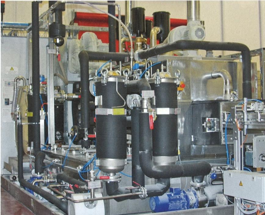
Die Filtereinrichtung des Reinigungssystems sorgt dafür, dass partikelfreies Wasser beim Wasch- und Spülvorgang zum Einsatz kommt
