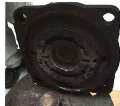
Mit der Spezial-Anlage von ATL können Werkstücke wie dieses Pumpengehäuseteil innerhalb kürzester Zeit thermisch entgratet werden.
