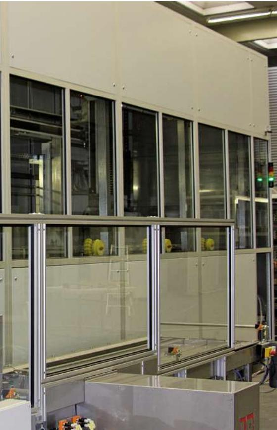
**Großanlage zur Reinigung von Edelstahlringrohrchargen mit 280 kg Chargengewicht. Nach der Tauchbadreinigung müssen die Teile schmutz-, öl-, seifen- und fleckenfrei sein.**
