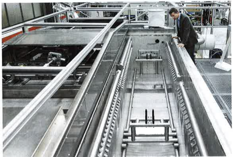
In der neuen Anlage bei VAT können verschiedene Bauteilgrößen – bis 4000 mm – und -geometrien drehend gereinigt werden
