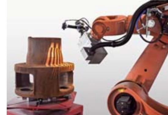
Die Bearbeitungsbahnen der Roboter werden durch dreidimensionales Vermessen der Bauteiloberfläche im Lichtschnittverfahren berechnet Bild: Theilinger
