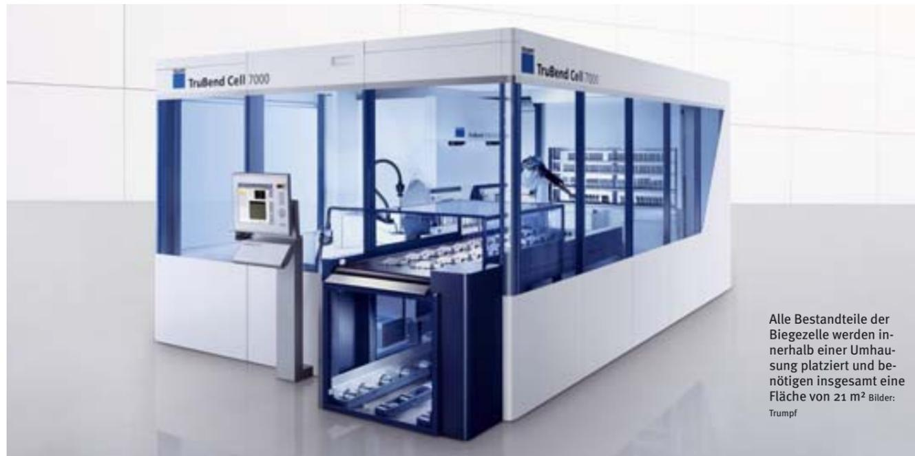
Alle Bestandteile der Biegezone werden innerhalb einer Umhausung platziert und benötigen insgesamt eine Fläche von 21 m<sup>2</sup>. Bilder: Trumpf
