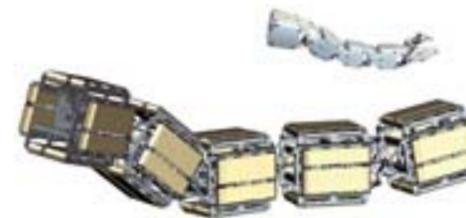
Steuerung mittels „Snake Controller“: der Traloc bildet nach, was der Bediener anhand eines verkleinerten Modells vormacht
