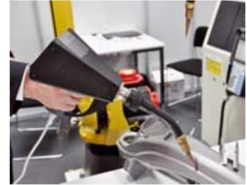
Der einfache Programmiervorgang funktioniert auch mit einem Werkstück wie zum Beispiel einer Schweißspitze
