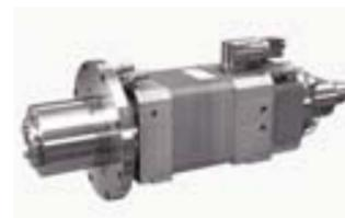
verfügt über eine Leistung von bis zu 11,5 kW, erreicht Drehmomente bis zu 21 Nm und Drehzahlen bis 24.000 min<sup>-1</sup>. Die Variante 100 ist mit der Werkzeugschnittstelle SK40 ausgeführt, hat eine Leistung von bis zu 18,5 kW, erreicht Drehmomente bis 53 Nm und Drehzahlen bis 18.000 min<sup>-1</sup>. Maschinenhersteller profitieren von den deutlich kompakteren Abmaßen was den Einbau vereinfacht und beschleunigt.
