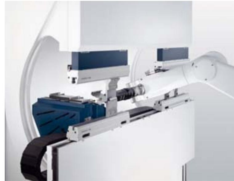
Der Roboter BendMaster ist fixer Bestandteil der Zelle. Mit seinem Zangengreifer kann er Bauteile bis 500 mal 380 mm Größe und einer Blechdicke bis zu 8 mm präzise positionieren
