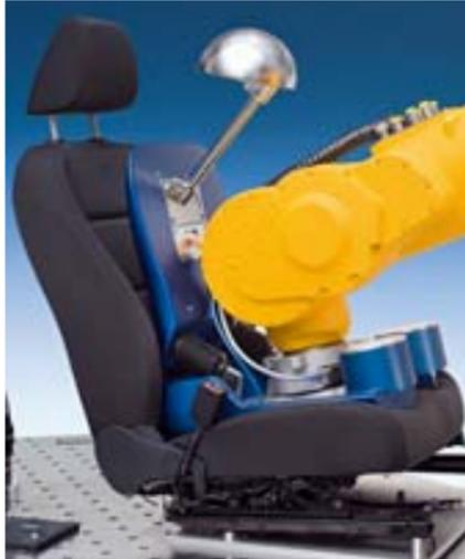
Der Roboter ist an der Hand mit einem dreiachsigen Kräfte-Momenten-Sensor ausgestattet, an dem der Dummy montiert ist Bild: Battenberg
