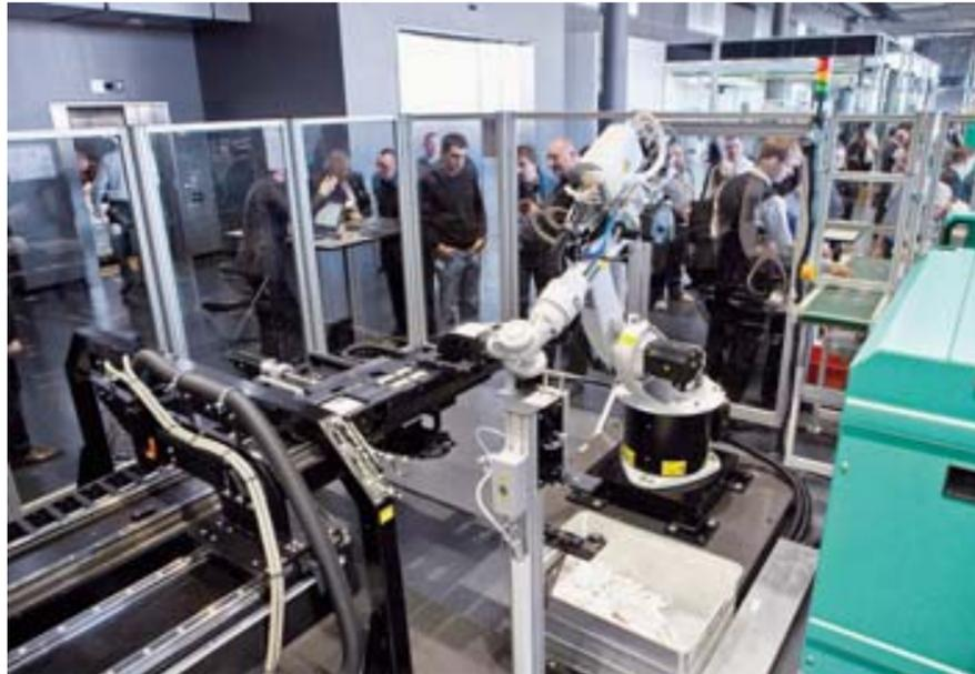
In dieser vollautomatisierten Fertigungszelle wurden auf den Arburg Technologie-Tagen Namensschilder für die Besucher im Spritzgießprozess hergestellt und anschließend bedruckt Bild: Arburg
