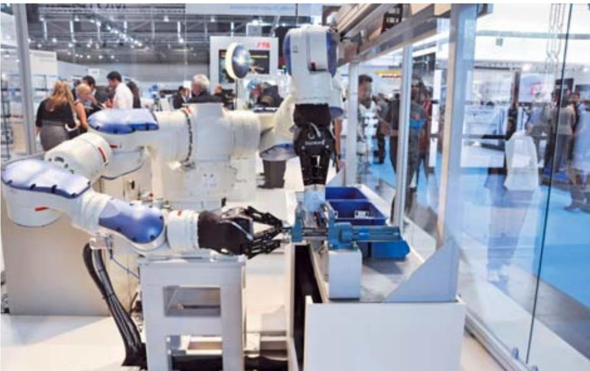
Der humanoide Roboter bei der Arbeit: Seine beiden Arme sind jeweils mit einem Dreifinger-Greifsystem ausgestattet, mit denen Werkstücke und Werkzeuge sicher gegriffen werden können
