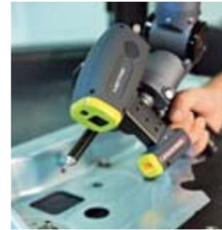
Hohe Flexibilität in der Fertigung kleiner Serien: Dieses Ziel erreicht Nikon Metrology durch „Additive Manufacturing“: Der Messgeräte-Hersteller lässt das Gehäuse des Handheld-Scanners K-Scan MMDx von der Materialise B.V. lasersintern. Handgeführte Laserscanner werden beispielsweise zum Reverse Engineering eingesetzt. Das Nikon-Metrology-Messgerät ist mit einer dynamischen Objektreferenzierung ausgestattet, die eine Bewegungskompensation
