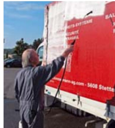
Das Schaumgerät Foam-Matic 5P erzeugt ohne zusätzliche Pressluft einen sehr trockenen, lang haftenden Schaum. Das tragbare 5-l-Gerät erleichtert damit das Reinigen von Duschräumen, Geräten in Küchen und Metzgereien, Fahrzeugen und Baumaschinen. Diese Schaumqualität wird durch ein neues Schaumsystem erzeugt. Ein großes Druckpolster
