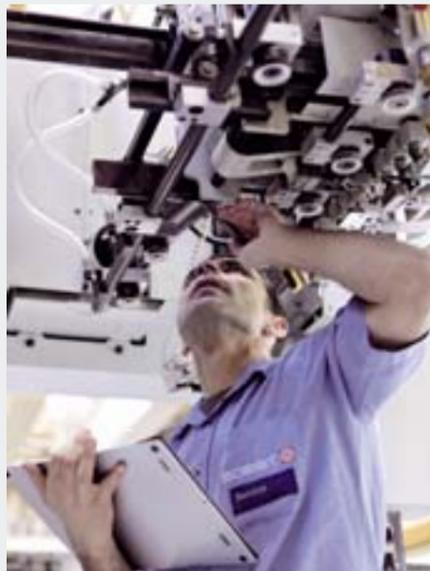
Beim Betreibermodell kommt es vor allem auch darauf an, dass die Maschinen vernünftig gewartet werden können. Deren Konstruktion sollte deshalb so gestaltet sein, dass die Nebenzeiten minimiert werden. „Serviceability“ heißt das Stichwort
