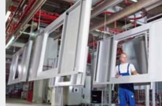
Die Pulverbeschichtung in der firmeneigenen Anlage garantiert eine qualitativ hochwertige Oberfläche der Elemente
