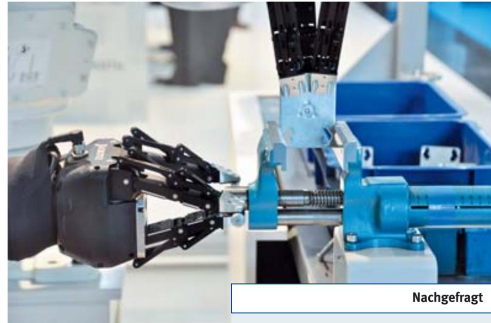
Ein Anwendungsbeispiel zeigt die Fähigkeiten des Roboters: Mit der linken Hand hält er ein Werkstück in den Schraubstock und mit der rechten Hand spannt er es fest
