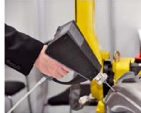
Und so funktioniert es: Mit einem Programmiergriff, der mit LEDs bestückt ist, fährt der Anwender über das Werkstück. Der Vorgang wird von Kameras verfolgt, in Koordinaten umgerechnet und in die Robotersteuerung überspielt. Danach fährt der Roboter die Bahn exakt nach Bild: Autor
