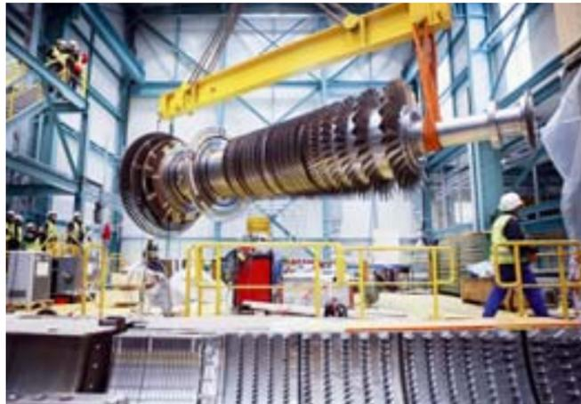
Die Anwendung im Visier: Zu den Spezialitäten von Europas erstem Kompetenzzentrum für Strömungsmaschinen gehören ganzheitliche Lösungen rund um Aggregate, hier eine Gasturbine für ein Kombikraftwerk
