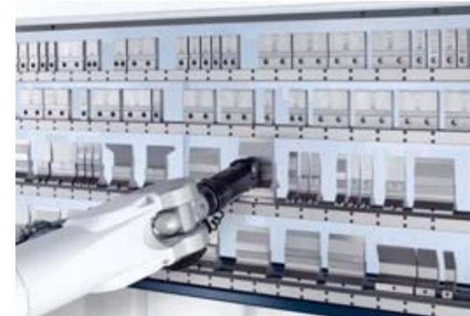
Für den Austausch der Biegewerkzeuge steht ein Werkzeugwechsler zur Verfügung, aus dem sich der Roboter die passenden Werkzeuge holt
