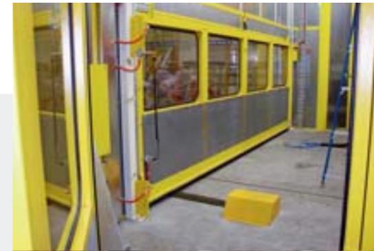
Schalldämmende Hubtore, komplett mit Antrieben und Sicherheitseinrichtungen ausgestattet, ermöglichen den Zugang zum Wechsel der Presswerkzeuge
