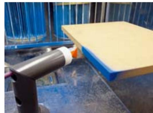
Das Pulver-Airbrushsystem verfügt über eine spezielle Flachstrahldüse, die die selektive Vorbeschichtung der Schmalflächen von Holzwerkstoffplatten erleichtert
