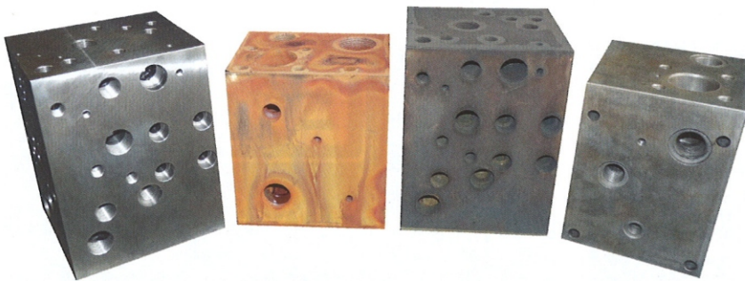
Bei Grauguss- und Stahlteilen lassen sich mit dem thermischen Entgraten hervorragende Ergebnisse erzielen – auch bei schwierigen Geometrien. Doch gerade hier entsteht durch den thermischen Entgratprozess eine Oxidschicht, die abgereinigt werden muss.
