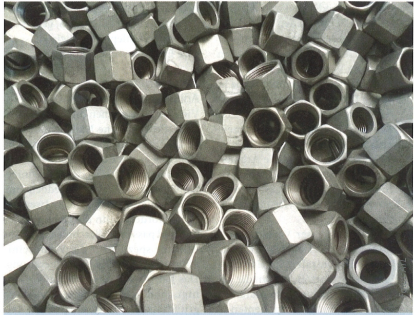
Schüttgut stellt aufgrund der großen zu entgratenden und zu reinigenden Gesamtoberfläche besonders hohe Anforderungen an das thermische Entgraten und die nachfolgende Reinigung
