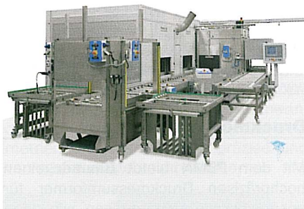
Die Anlage PowerJet Twin verfügt über zwei Arbeitskammern und eine Kühlstation
