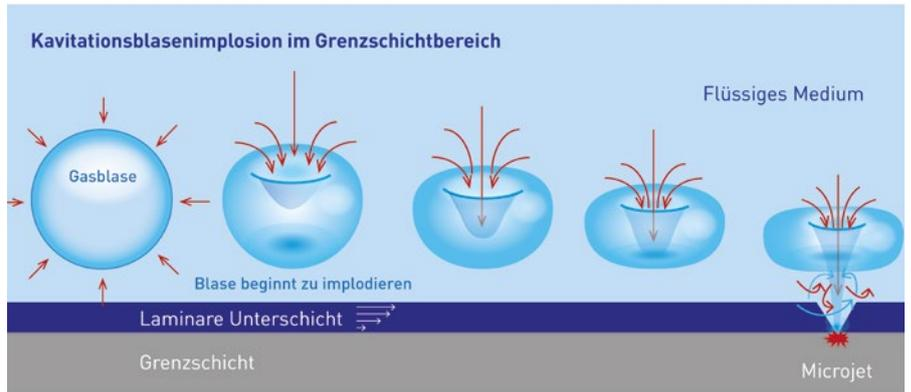
Bei der Implosion einer Kavitationsblase in Wandnähe, hier bei einer Ultraschallanwendung, durchbricht der Microjet die laminare Unterschicht und erzeugt neben der direkten Kraft auf der Grenzfläche zudem eine Vermischung der Medien und erhöht so deutlich die Reinigungseffektivität.
