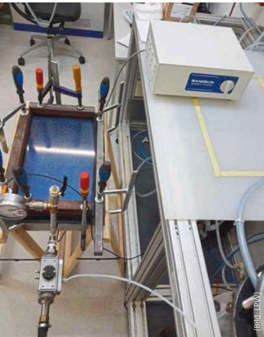
Halbautomatischer Testlauf mit Ultraschall und geheizten Medien
