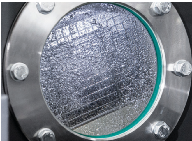
LPW-Anlage im Einsatz: Die Dampfassen während der Reinigung mit CNp sind typisch und inzwischen in zahlreichen Industriebetrieben mit unterschiedlichsten Anforderungen der hochwertigen Reinigung zu sehen.
