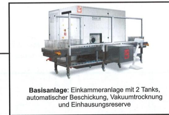
**Basisanlage:** Einkammeranlage mit 2 Tanks, automatischer Beschickung, Vakuumtrocknung und Einhausungsreserve
