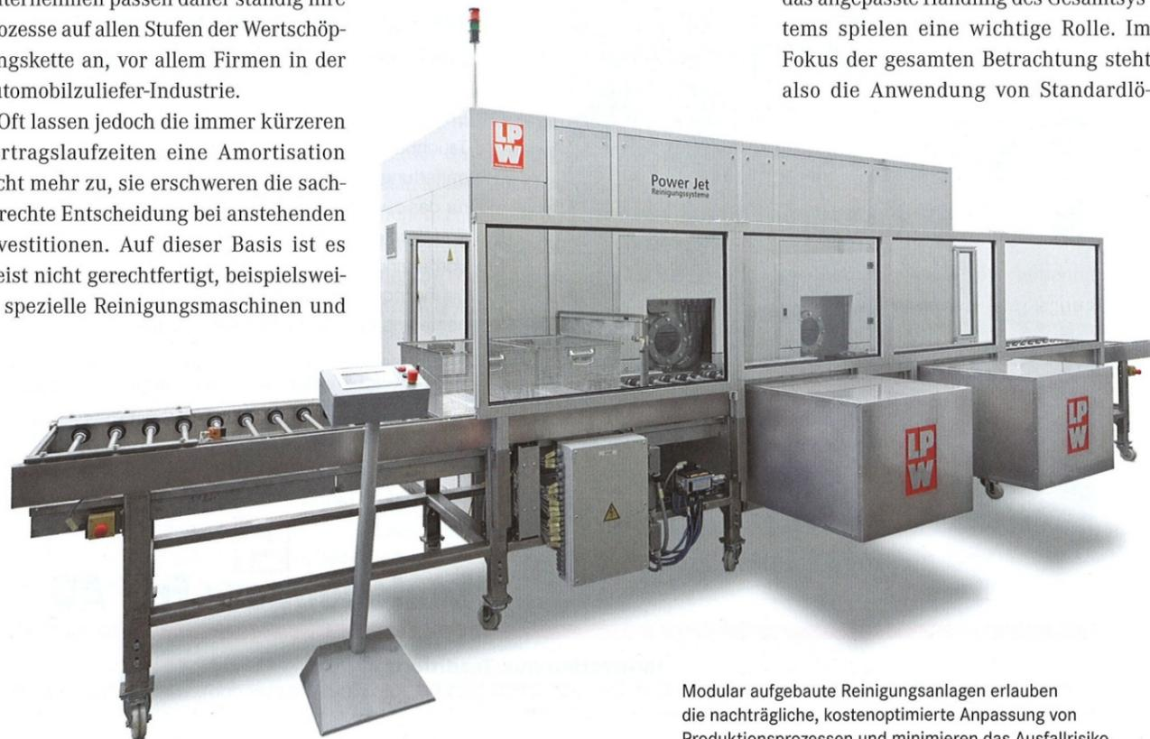
Modular aufgebaute Reinigungsanlagen erlauben die nachträgliche, kostenoptimierte Anpassung von Produktionsprozessen und minimieren das Ausfallrisiko
